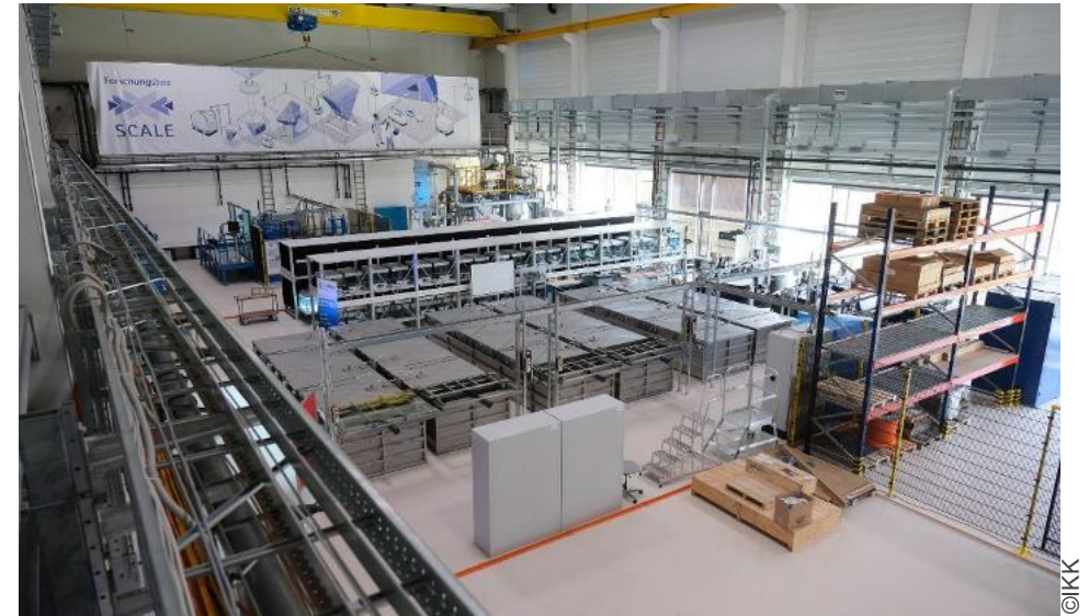
Technikum für aquatische Abbaubarkeitsuntersuchungen mit Wellenkanal-, Tidenhub- und Mikrokosmos-Systemen
