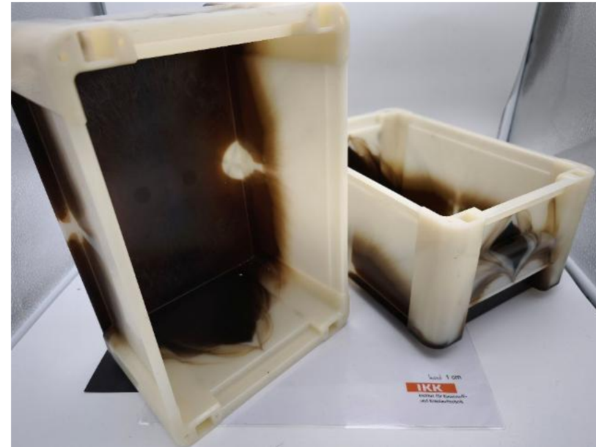
Kleinladungsträger (KLT) aus zwei Materialströmen: Rezyklatseite (dunkel): Rezyklat aus ausgedienten Fischernetzen Neuwareseite (hell): Neuwarekunststoff
