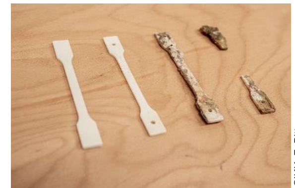
Kunststoffproben nach dem Abbau unter marinen Bedingungen
